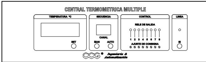
La central termométrica C-TD 20100 es un equipo diseñado para la medición de hasta 8 canales de entrada de temperatura para sensor tipo RTD Pt100, con un punto de control por cada canal preparado para calefacción ó refrigeración.
