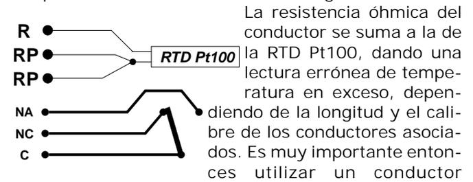
La resistencia óhmica del conductor se suma a la de la RTD Pt100, dando una lectura errónea de temperatura en exceso, dependiendo de la longitud y el calibre de los conductores asociados. Es muy importante entonces utilizar un conductor
